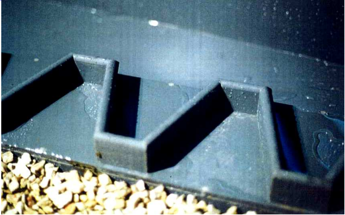
Figura 1.- Modelo reducido del aliviadero de vertido lateral con vertedero en laberinto de la presa de Biscarrués, río Gállego. Huesca
