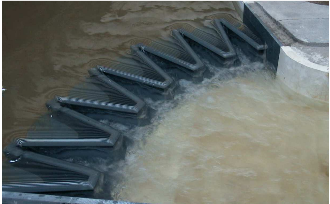
Figura 11.- Modelo reducido del laberinto de 7 módulos
