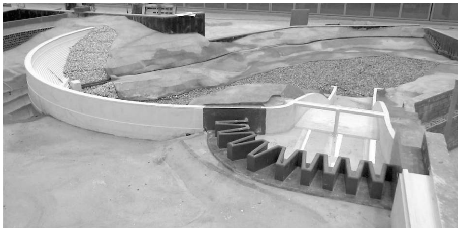
Fig N° 3: Modelo físico reducido del aliviadero de la presa de M a Cristina
